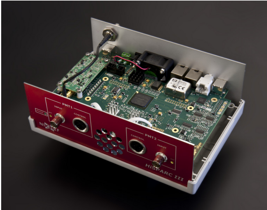
Figuur 2.1 – De HiSPARC master unit, foto uit [1]. In de blokken PMT 1 en PMT 2 zijn twee gele ledjes te zien. Deze lichten op als er deeltjes door respectievelijk detector 1 of detector 2 wordt gemeten. In de praktijk worden de detectoren ongeveer elke 10 ms geraakt. Achter de koelgaten is een witte led te zien. Deze licht op als beide detectoren binnen een tijdsinterval van 1,5 \mu\text{s} deeltjes waarnemen, dit komt veel minder vaak voor.
