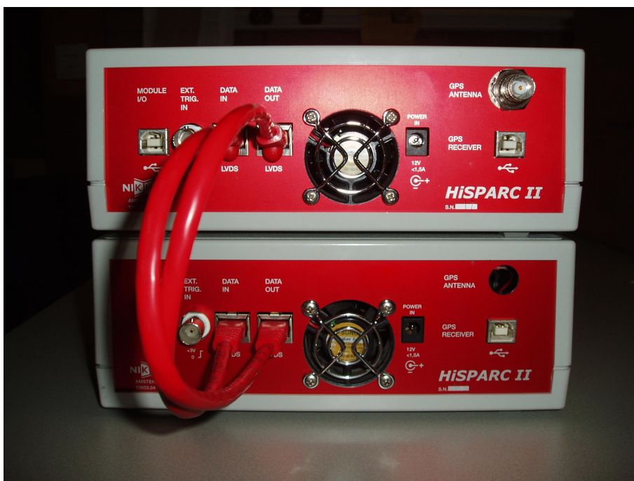
Figuur 1.3 – Een snelle databus verzorgt de communicatie tussen HiSPARC II Master en Slave; de verbinding bestaat uit twee kabels die 'LVDS data in' en 'LVDS data out' (kruislings) met elkaar verbinden.
