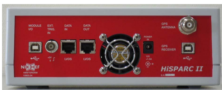
Figuur 1.2 – De achterzijde van de HiSPARC II Master; van links naar rechts: USB aansluiting voor het versturen van de meetgegevens naar de pc, TTL aansluiting voor een externe trigger (alleen voor speciale doeleinden), twee UTP verbindingen (niet van toepassing), uitgang luchtkoeling, aansluiting voedingsadapter (12 Volt DC, 1.5 A), GPS antenne aansluiting (rechtsboven) en USB verbinding voor het aanpassen van de GPS instellingen.
