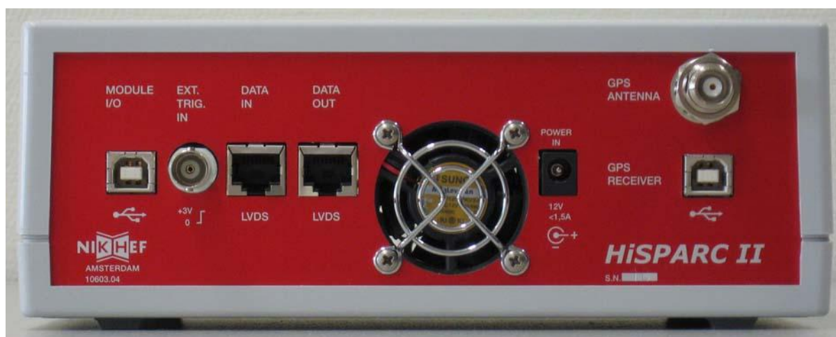
Fig. 1.2: De achterzijde van de HiSPARC II Master; van links naar rechts: USB aansluiting voor het versturen van de meetgegevens naar de pc, TTL aansluiting voor een externe trigger (alleen voor speciale doeleinden), twee UTP verbindingen (niet van toepassing), uitgang luchtkoeling, aansluiting voedingsadapter (12 Volt DC, 1.5 A), GPS antenne aansluiting (rechtsboven) en USB verbinding voor het aanpassen van de GPS instellingen.
