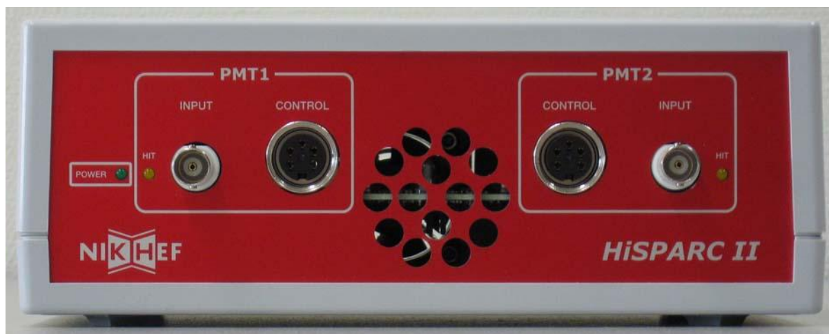
Fig. 1.1: De voorkant van de HiSPARC II Master; van links naar rechts: groene LED voor de voedingsspanning, de gele LED geeft aan of er signalen binnenkomen, signaal- en voedingsaansluiting voor fotobuis-1. Midden: de inlaat voor de luchtkoeling. Rechts in omgekeerde volgorde: voedings- en signaalaansluiting fotobuis-2 en gele signaal LED.
