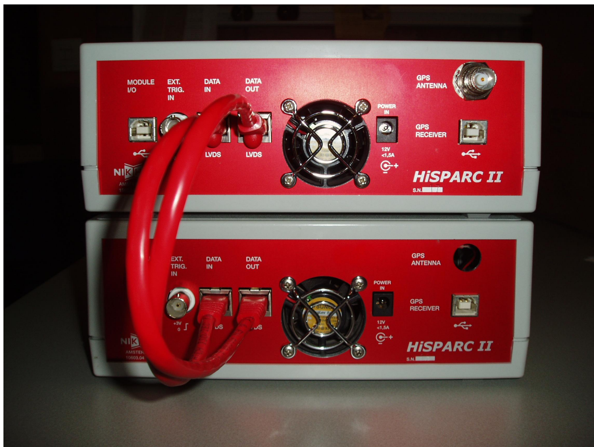
Fig. 1.5: Een snelle databus verzorgt de communicatie tussen HiSPARC II Master en Slave; de verbinding bestaat uit twee kabels die 'LVDS data in' en 'LVDS data out' (kruislings) met elkaar verbinden.
