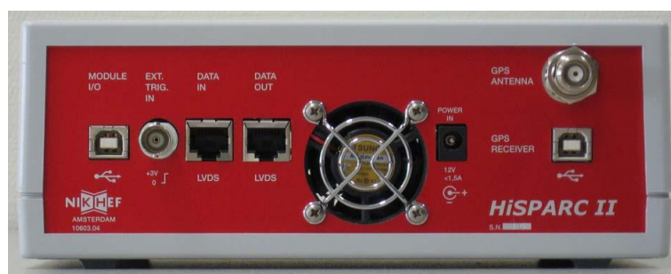
Figuur 1.2 – De achterzijde van de HiSPARC II Primary; van links naar rechts: USB aansluiting voor het versturen van de meetgegevens naar de pc, TTL aansluiting voor een externe trigger (alleen voor speciale doeleinden), twee UTP verbindingen (niet van toepassing), uitgang luchtkoeling, aansluiting voedingsadapter (12 Volt DC, 1.5 A), GPS antenne aansluiting (rechtsboven) en USB verbinding voor het aanpassen van de GPS instellingen.
