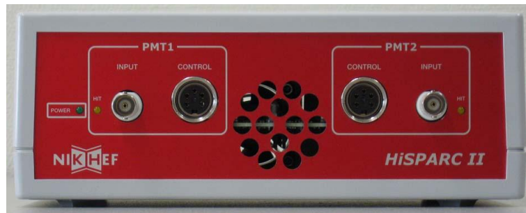
Figuur 1.1 – De voorkant van de HiSPARC II Primary; van links naar rechts: groene LED voor de voedingsspanning, de gele LED geeft aan of er signalen binnenkomen, signaal- en voedingsaansluiting voor fotobuis-1. Midden: de inlaat voor de luchtkoeling. Rechts in omgekeerde volgorde: voedings- en signaalaansluiting fotobuis-2 en gele signaal LED.
