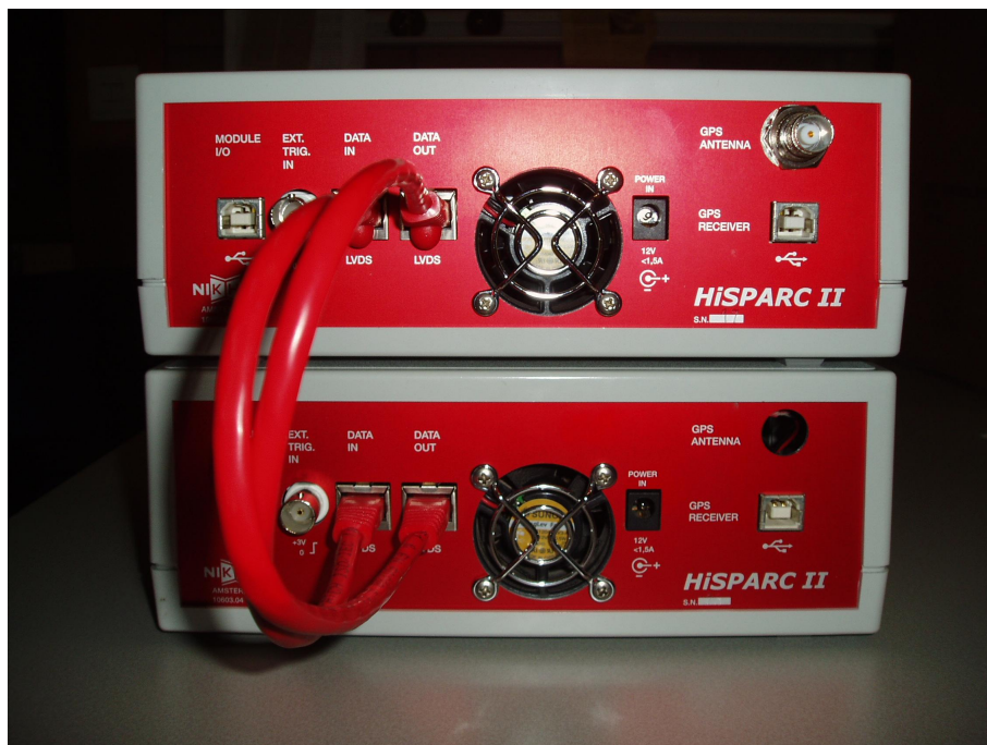
Figuur 1.3 – Een snelle databus verzorgt de communicatie tussen HiSPARC II Primary en Secondary; de verbinding bestaat uit twee kabels die 'LVDS data in' en 'LVDS data out' (kruislings) met elkaar verbinden.
