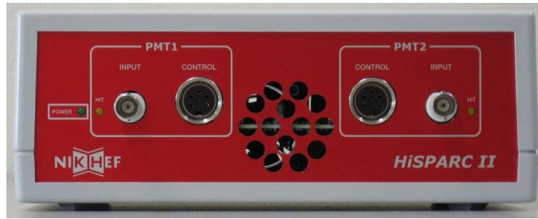
Figuur 1.1 – De voorkant van de HiSPARC II Master; van links naar rechts: groene LED voor de voedingsspanning, de gele LED geeft aan of er signalen binnenkomen, signaal- en voedingsaansluiting voor fotobuis-1. Midden: de inlaat voor de luchtkoeling. Rechts in omgekeerde volgorde: voedings- en signaalaansluiting fotobuis-2 en gele signaal LED.
