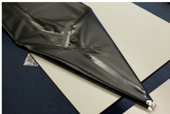
Figuur 5.3 – De detector helemaal ingepakt, op aansluitblokje en PMT na.
