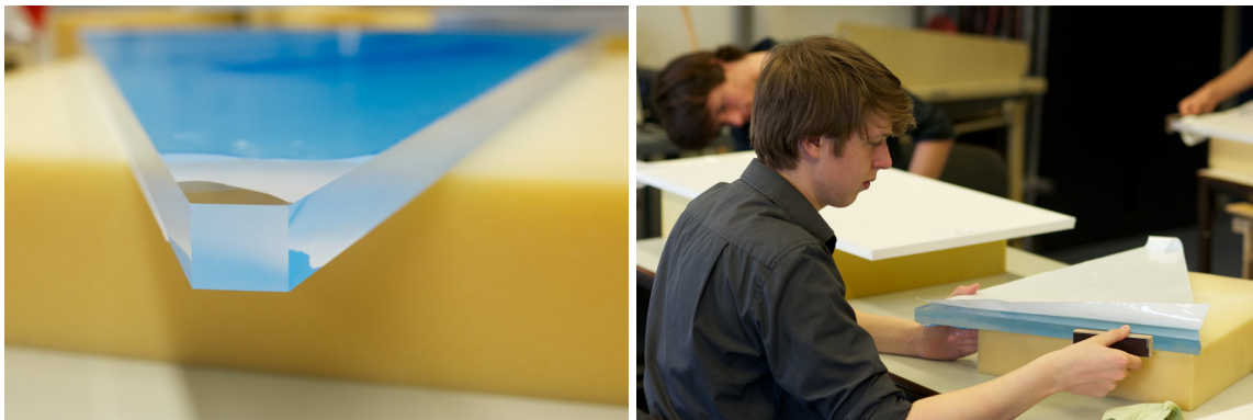
Figuur 3.2 – Het schuren van de lichtgeleiders en scintillatoren.
