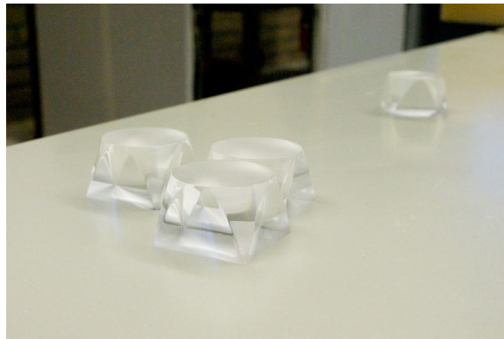
Figuur 3.3 – De aansluitblokjes tussen de lichtgeleider en de PMT.
