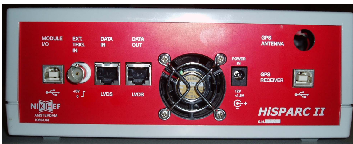
Fig. 4: Data van de HiSPARC II Slave wordt uitgelezen via de linker USB verbinding. De Slave heeft geen aansluiting voor een GPS antenne kabel (rechtsboven); de rechter USB aansluiting is zonder functie.
