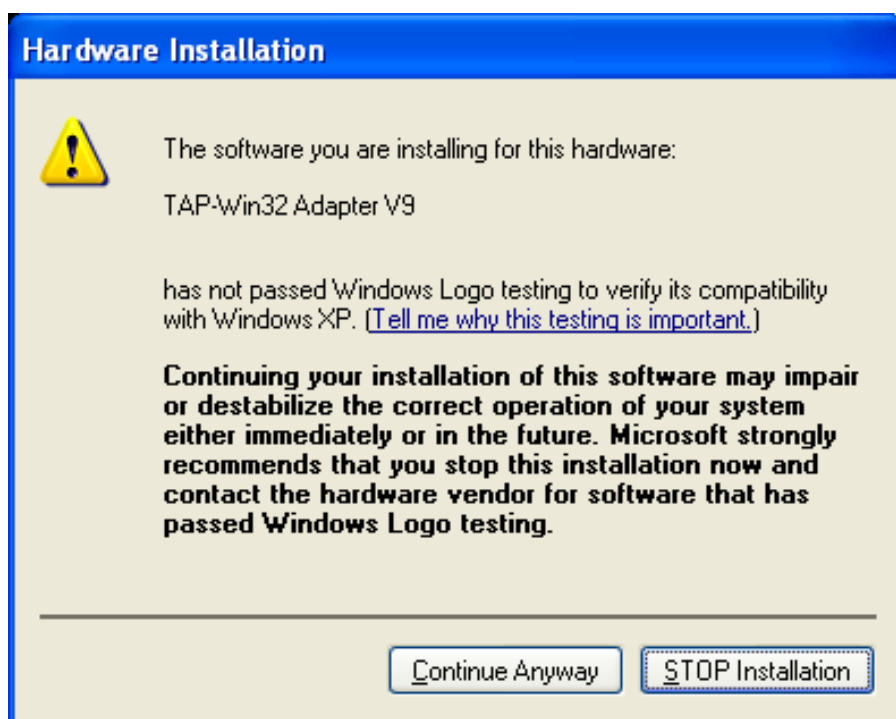
Fig. 14: De installatie van de TAP driver (virtuele netwerkkaart voor OpenVPN) is niet officieel door Microsoft gecertificeerd. Daarom moet u expliciet toestemming geven voor de installatie.
