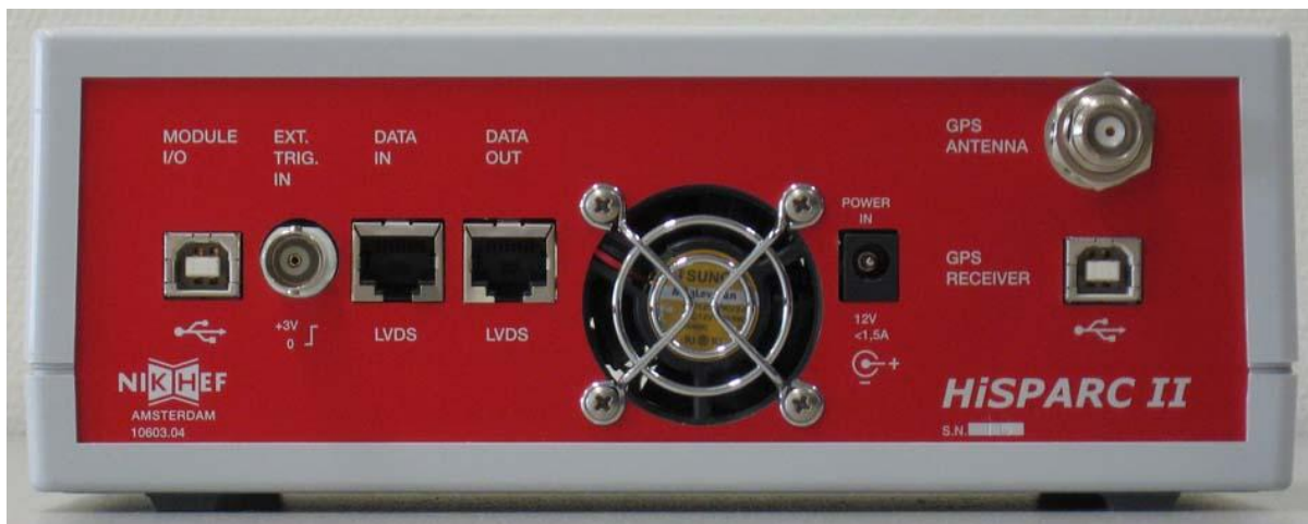
Fig. 2: De achterzijde van de HiSPARC II Master; van links naar rechts: USB aansluiting voor het versturen van de meetgegevens naar de pc, TTL aansluiting voor een externe trigger (alleen voor speciale doeleinden), twee UTP verbindingen (niet van toepassing), uitgang luchtkoeling, aansluiting voedingsadapter (12 Volt DC, 1.5 A), GPS antenne aansluiting (rechtsboven) en USB verbinding voor het aanpassen van de GPS instellingen.
