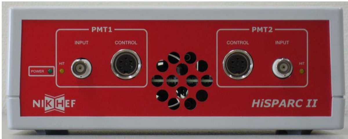
Fig. 1: De voorkant van de HiSPARC II Master; van links naar rechts: groene LED voor de voedingsspanning, de gele LED geeft aan of er signalen binnenkomen, signaal- en voedingsaansluiting voor fotobuis-1. Midden: de inlaat voor de luchtkoeling. Rechts in omgekeerde volgorde: voedings- en signaalaansluiting fotobuis-2 en gele signaal LED.
