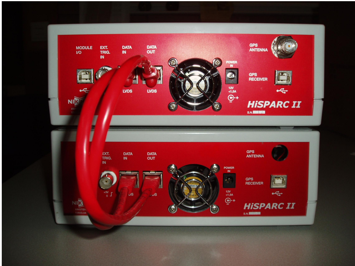
Fig. 5: Een snelle databus verzorgt de communicatie tussen HiSPARC II Master en Slave; de verbinding bestaat uit twee kabels die 'LVDS data in' en 'LVDS data out' (kruislings) met elkaar verbinden.
